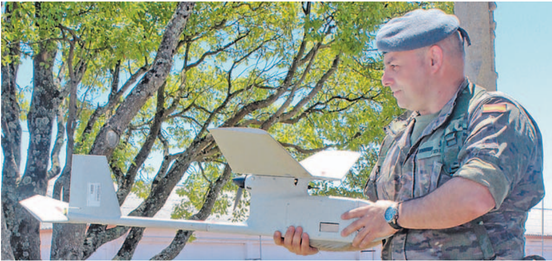
Los drones que empleará la Brilat tienen un alcance de diez kilómetros y una autonomía de aproximadamente noventa minutos. LUZ CONDE
